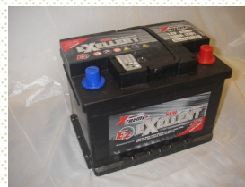
12V 60Ah CCA540A(EN). Art.nr SX1090 Lxbxh=242x175x175mm (höjd med pol) Vikt 15,3 kg
