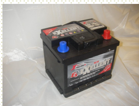
12V 50Ah CCA420A(EN). Art.nr SX1040 Lxbxh=207x175x175mm (höjd med pol) Vikt 12,8 kg
